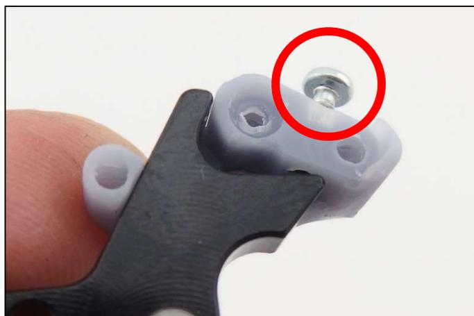
右側のマグネットアダプターを取り付け、3か所のねじをゆっくり締め込みます。
