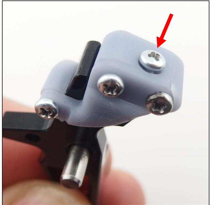
マグネットアダプターがセクターギアに干渉しないか確認します。もし干渉する場合はマグネットアダプターを削って調整してください。
