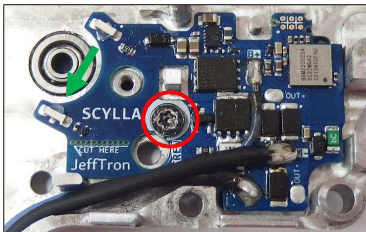
値が小さすぎる場合、逆方向にずらしてセンサーをセクターギアから遠ざけるか、センサーを掃除してください。
