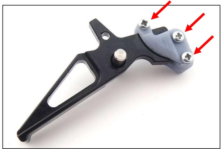
頂点にあるねじは、様々な形状のトリガーに対応するためのガタ取り用の調整ねじです。ガタが無くなるまでゆっくり締め込みます。
