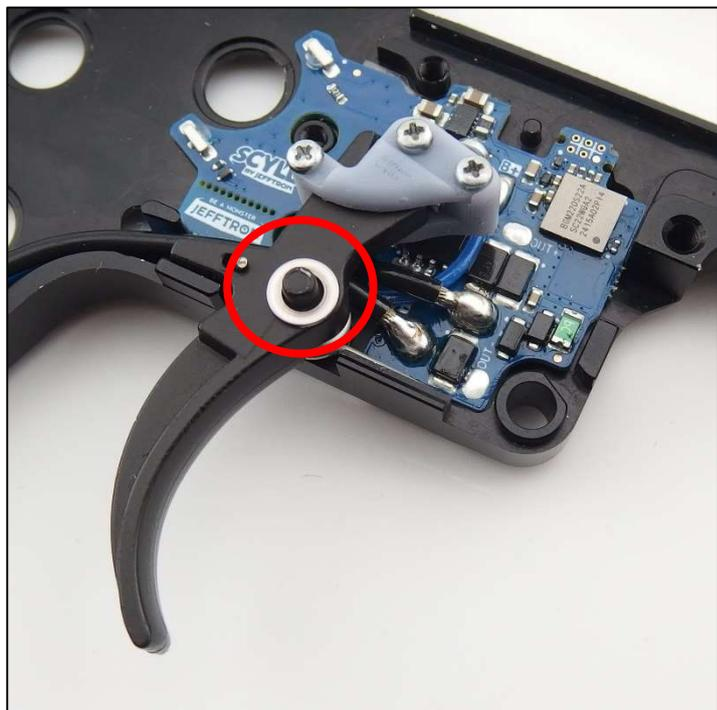
2) 1)の方法でも解消しない場合、ギアボックス右側にある写真赤丸部分の突起を削ってください。
