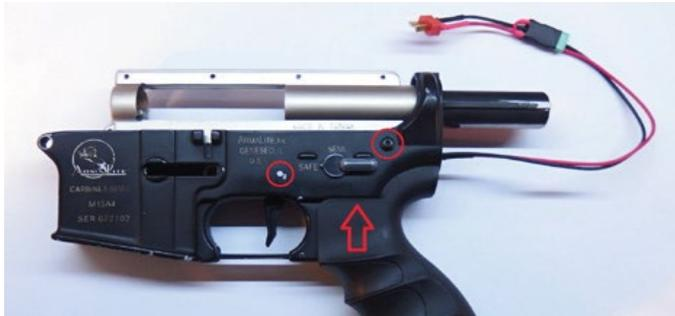
28. ギアボックスをレシーバーに組み付け、ピンとネジで固定します。
