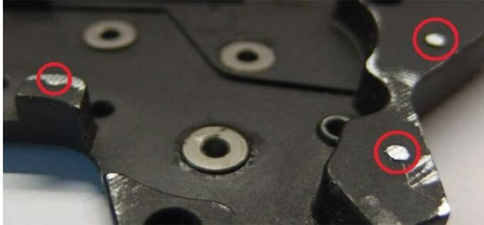
14. ギアボックスに配線押さえがあれば、削って平らにします。
