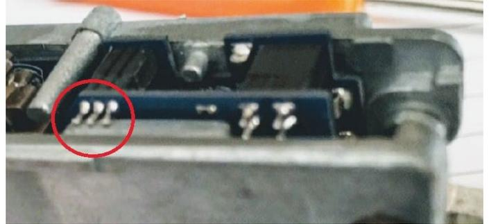
9. ICSギアボックスに使う場合、赤丸部分を削ってはんだ付け部分が接触しないようにします。
