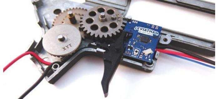
27. 残りのギアを組み付けてギアボックスを閉じます。
