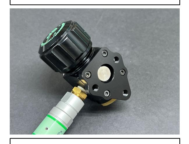
続いてS-Sアダプターを付属のM3x6六角キャップボルトでSP-18000に取り付けます。 ねじ部分には緩み止め剤の使用をお勧めします。
